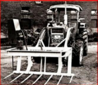
Vid frontlastaren har man en bättre översikt. Höjden på tömmaren bestäms av frontlastaren, och den är tillräcklig. Blockstorleken kan bestämmas av traktorföraren själv.
