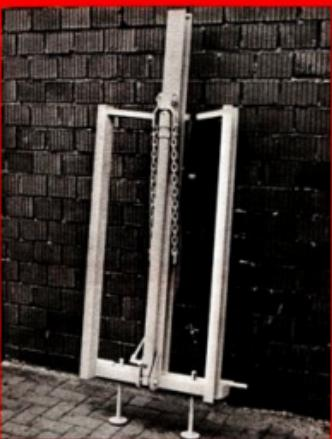
Höglyft för trepunktshydraulik upp till 2,50 meter silohöjd, och den passar till alla tre plansilotömmarna.
