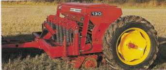
4. Dubbelverkande hydraulcylindrar och vipparmsaxel.
