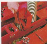
5. Justering av säbillarnas parallellgram
