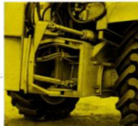
Ramsystemet, som innebär att motorenheten vinklas mot lastenhetens axel genom att ruttuttaget påverkar två hydraulcylindrar via en hydraulventil. Detta styrsystem ger en lätt, följsam styrning och full dragkraft på alla hjul även under sväng.
