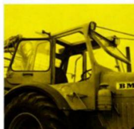
Kraven på förfarankarhet är väl tillgodosedd i den synliga och dragriva gummihängbara stålhytten. Front- och bakrutor är öppningsbara, och kan fixeras i önskad position, dessutom finns taklucka, som liksom dörrarna vid behov kan fästas i öppet läge.
