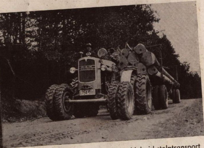
M·A·N Ackerdiesel med dubba hjul vid stolptransport
