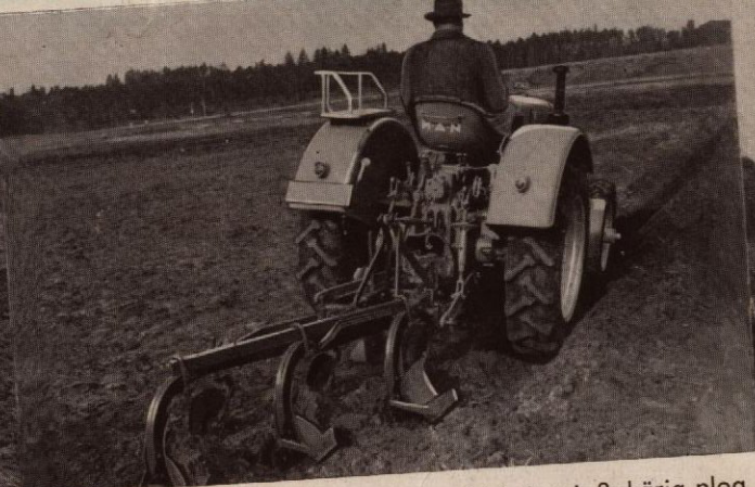
M·A·N Ackerdiesel med hydraulisk lyft och 3-skärig plog
