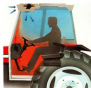
Värme- och ventilationsystemet med två temperaturzoner gör att du kan hålla fötterna varma och huvudet kyllt
