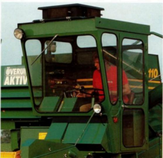
ger en god sikt och genom hyttventilatorn blåses ren, filtrerad luft in i hytten. Luftmängden kan regleras genom att ventilatorns fläkt har tre olika hastigheter och luftströmmen kan riktas genom ställbara munstycken.
