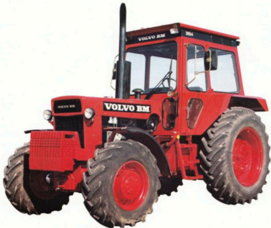
Kraftfull, teknisk och förarvänlig — det är Volvo BM 2654. Den "vassa" 6-cylindriga Volvo-dieseln med turboladdning utvecklar 140 hk DIN som i kombination med stora däck och fyrhjulsdraft på samtliga växlar gör 2654 till en råstark dragare i alla väglag.
