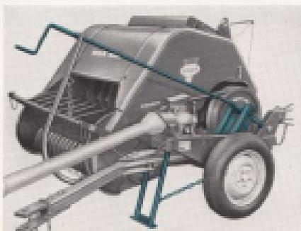
Veven till pickup-rullens lyftmechanism har en dubbelfunktion. Den kan fästas med denna under glid höga eller lårla pickup-rullen. Den underlättar den till- och fräskopplingen av draganordningen genom att veven är förbunden med precisionssädet.
