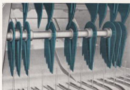
De roterande inmatningsvingarna (Patent WELGER) ger ett uppdelningsfritt genomflöde. Genom de nio vingepetstensas roterande rörelse följer kolven material.
