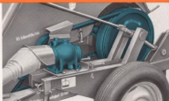
Den solida vinkelvinseln i objektet förvarar mycket liten tillväxt och till stora påfrestningar. Klyftessamma tjänar som elastisk link vid kraftöverföringen. Svänghjulet har bryggjärn som skydd mot överbelastning. Preditionskedjer driver kolven och bindverket. Denna enkla driftskombination garanterar hög gevärmöjlighetsförliga, lågt glid och säkerhet mot överbelastning.
