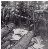
Standardkran monterad på traktorns hydraul.
