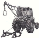
Spezialkran för Ferguson m. fl. icke monterad i hydraul. Spelet uppbyggt med kedjedrift.
