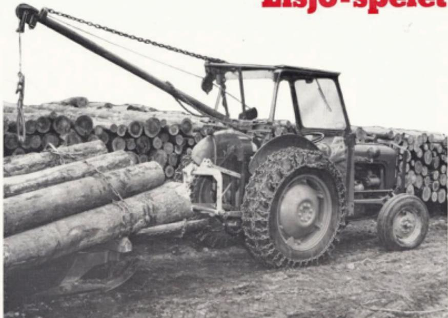
Bilden visar en skogstraktor MF 35, monterad Lisjö-spel och Stenby-kälke. En ekonominisk kombination för skogsbruket.
