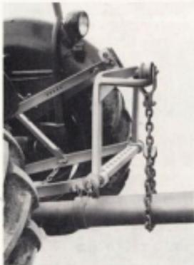
*Belastningskopplingen har ett stort användningsområde. Bogserade harvar, vältar, bogserade kultivatorer, bogserade skördetröskor, tvåaxlade vagnar, såmaskiner och stallgödselspridare är exempel på redskap, som med hjälp av belastningskopplingen kan ge ökad drivbjuksbelastning till traktorn — utan att ekipagets totala vikt ökas.*
