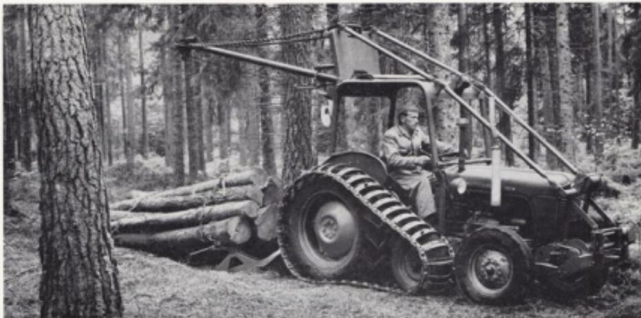
Massey-Ferguson timmerkälke är trepunktshängd och försedd med svängbar taggbänke. Den är robust byggd men ändå smidig. Medarna är av laddkonstruktion och varje med är försedd med två utbytbara slitskenor, som även förhindrar glidning i sidled.
