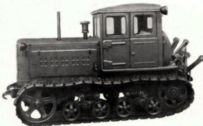
**Гусеничный трактор ДТ-55А** представляет собой болотную модификацию трактора ДТ-54А и предназначен для работы в местностях с заболоченным грунтом и для обработки почвы на осушенных болотах и торфяных полях в агрегате с различными сельскохозяйственными и мелиоративными машинами.
