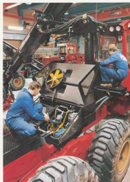
Skördarens processordel monteras komplett innan den monteras slutligt på chassi.
