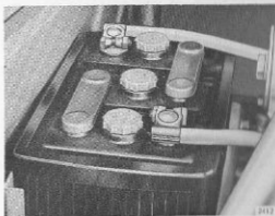
Fig. 26. Kontroll av batteriet.
