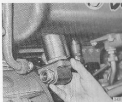
Fig. 38. Demontering av sugsil.
