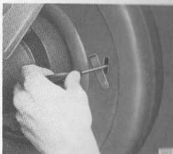
Fig. 41. Justering av bromsarna.
