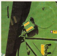
Sällen, luftmängden och luftriktningen kan ställas och kontrolleras under arbetets gång.
