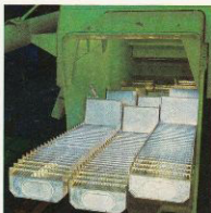
4 trappsteg på varje skakarläda — effektiv hast rörelse och avskiljning.
