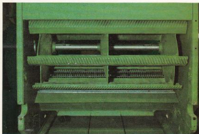
Tröskcyllindern väger 94 kg, är 850 mm lång och har 550 mm diameter.
