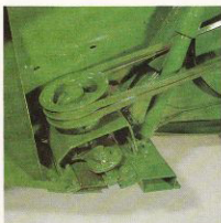
Knivhastigheten är hög, 510 v/min. Konstruktionen är kompakt och har få rörliga delar.
