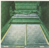
Delad skrapelevator — ställbara lamellslål.
