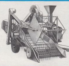
Bilden visar skördetröskan monterad med pick-up-rulle, vilken medverkar till minsta spill vid stränglagd gräsa.
