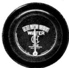
Bild 7. Bild av värmemätaren med det läge visaren bör ha, då motorn har den lämpligaste driftstemperaturen.
