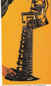
Hydrauldriven, sidmonterad slätter med dubbelkniv.
