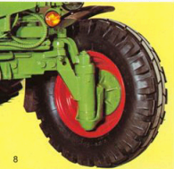
Teleskopisk framaxel med framhjulsfjädring.
