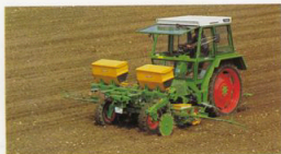
Målsådd och radgödsling i ett moment.
