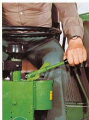
Kraftuttagen kopplas lätt i och ur under belastning.
