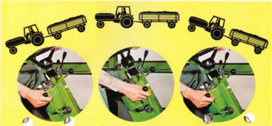
Reduktionsväxelpak för ökning av dragkraft resp. hastighet
