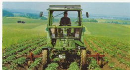
Kultivering av potatis med mittmonterad radkupare.
