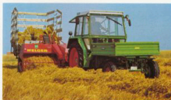
Tätstegad växellåda, belastningsbar kraftuttagskoppling och den höga vikten på drivaxeln är stora fördelar vid halmpresser
