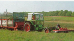
Slätter och lastning i ett moment. Frontmonterad rotorslätter kombinerad med självlastarvagn.
