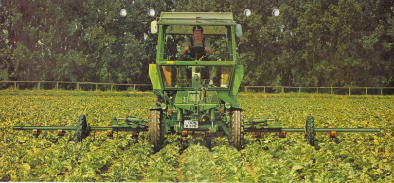
Den 12-radiga bethackan täcker upp till 3 ha per timme. En central vridpunkt i ramen och med stödhjul som tilläggsutrustning följer redskapet markytans alla ojämnheter.
