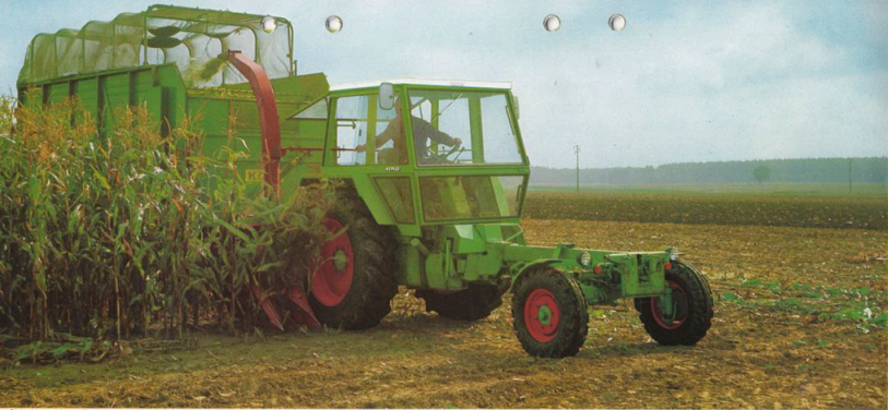
Skörd av majsensilage med redskapsbäraren. Den kraftiga motorn, det under belastning inkopplingsbara kraftuttaget och den tätstegade växellådan gör maskinen väl anpassad till tyngre jobb med kraftuttagsdrivna redskap.
