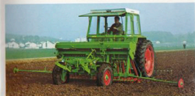
3-meters mittmonterad såmaskin. Utsådet kan transporteras bakom eller ekipaget eftersom draganordning här ej användes.
