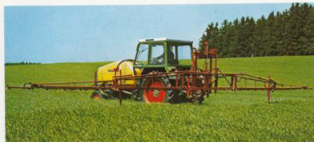
Ogrässpruta med mittmonterad 1400 liters väsktank och sprutramp av valfri bredd
