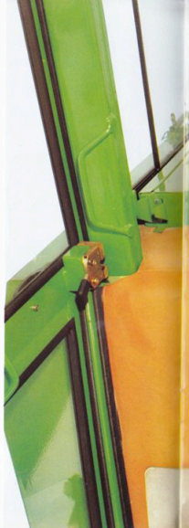
Gjutet hårdplasttak med taklucka för dragfri ventilation.
