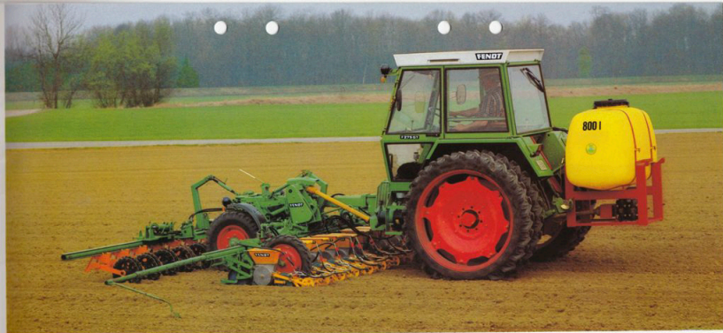
12-radig mittmonterad specialsåmaskin med bandspruta och frontmonterad radvält. 800-liters spruttank aktermonterad. Fältkapacitet upp till 20 ha per dag.
