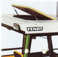
Gjutet hårdplasttak med taklucka för dragfri ventilation.
