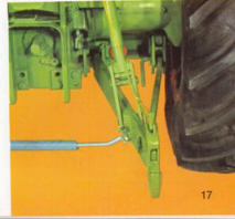
Automatisk sidostabilisering av dragstängeln.
