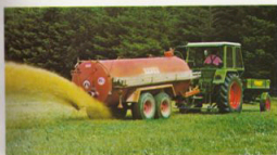
Hög dragkraft och kraftuttag inkopplingsbart under belastning är viktiga fördelar vid körning med flytgödselspridare.
