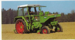
Den 2-radiga, mittmonterade automatiska potatisåttaren demonstrerar ytterligare överlägsenheten i Fendts enmanssystem.
