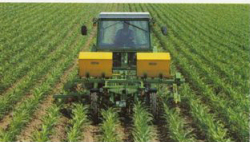
Radkultivator för majs som här monterats tillsammans med redgödselinslaggregat.
