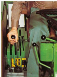
Växelspak för helsynkroniserad växellåda.
