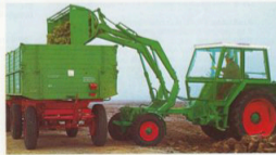
Konstruerad för att utrustas även med större frontlastare blir redskapsbäraren en lastmaskin med överträffad sidostabilitet.
