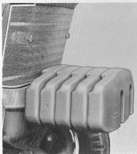
Fig. 28 Belastningsvikter för traktorns främre ände
