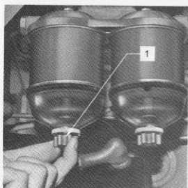
Fig. 38 Avtappning av vatten från bränslerenare
