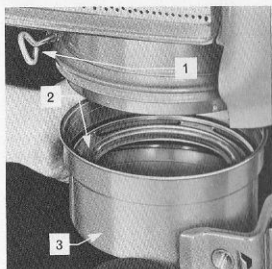
Fig. 30 Borttagning av luftrenarens oljebehållare
