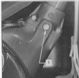
Fig. 55 Nivå- och påfyllningsplugg på styrväxeln
