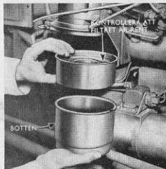
Fig. 18. Borttagning av luftrenarens botten.
