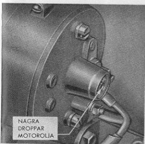
Fig. 16 Generatorns smörjning
