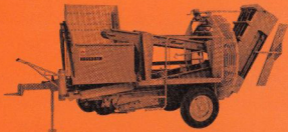
RB med hydrauliskt tippbar samlingsbehållare rymmande ca 1100 kg.
