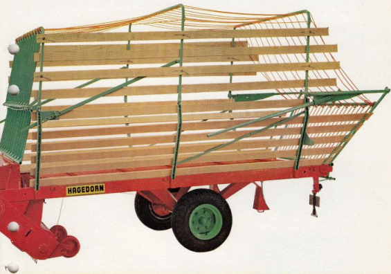
Självlastervagn utrustad som transportvagn. Lastkapacitet ca 3 ton.
