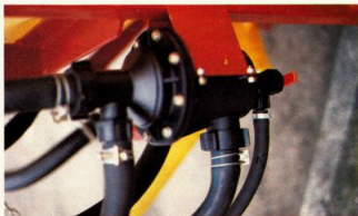
Självrensande filter förhindrar stopp i munstyckena.
