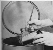
Bild 24. Rengöring av oljerensarens insats i dieselbränsle.
