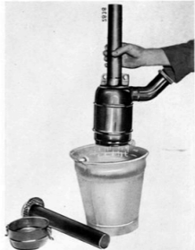
Bild 28. Rengöring av luftrenaren i ren dieselloja.
