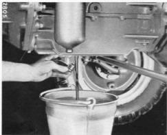
Bild 21. Avtappning av motoroljan. Avlägsna slam och avsättningar från hålet i avtappningspluggen innan den sätts tillbaka.
