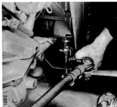
Bild 35. Avtappning av kylsystemet. Stäng inte kranen förrän systemet skall fyllas på nytt.
