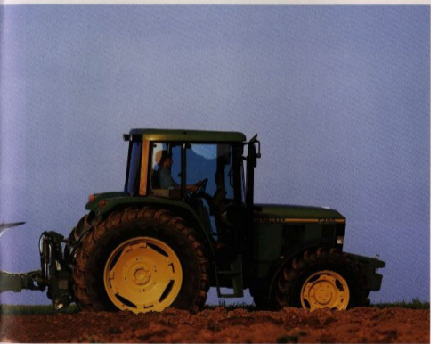
12° castervinkel möjliggör snäva svängar – även med inkopplad fyrhjulsdrift!
