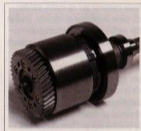
Den mycket hållbara, olijebäda framhjulskopplingen är konstruerad för att överföra höga vridmoment till framhjulen.
