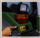
In- och urkoppling av kraftuttaget kan även ske från den bakre, vänstra stänkskärmen på traktorn (extrautrustning).
