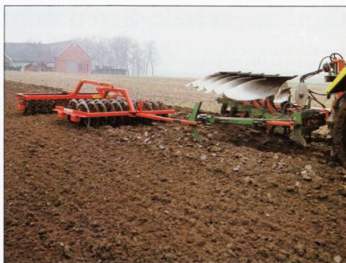
Gårdar med lätta jordar använder med fördel s k knastervält för att därigenom få färdig såbädd direkt efter plöjet. Observera skillnaden i struktur före och efter tiltpackaren.
