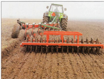
På tegplogar monteras en dragarm till vilken dragkedjan kopplas. Tiltpackaren följer med upp på vändtegen.
