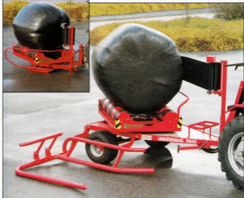
Färdigemballerad rundbal, färdig att tippas ner på marken.
