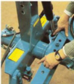
Överums nya växelplog är lättjusterad bl a genom att sidolutningen för vänster- resp högerplöjning kan justeras separat till vardera sidan. Dessutom lättanpassad till traktorns olika spårvidder.
