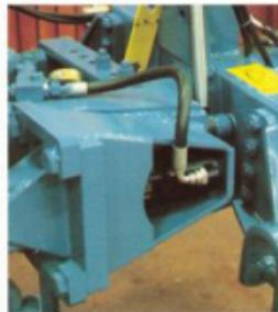
Överums nya växelplog är väl skyddad mot sönderköningar först och främst genom en kraftig konstruktion och den välkända hydrauliska helautomatiska stenutlösningen.
