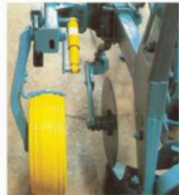
Överums nya växelplog växlar mycket mjukt och säkert. Pendelhjulet är dessutom väl skyddat mot hårdas slag vid vändningar genom en hydraulisk stötdämpare.
