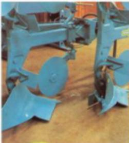
Överums nya växelplog har 90 cm mellan plogkropparna. Under besvärliga förhållanden krävs det att plogen har god rymlighet, för att plöjningen ska ske störningsfritt.
