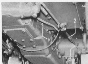
Fig. 5 1. Nivåkontrollplugg 2. Vänster bromsstag 3. Vänster bromsarm
