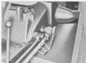
Fig. 24 Växelpak för kraftuttagsaxel 1. Hastighetsberoende kraftuttag 2. Friläge 3. Standardkraftuttag
