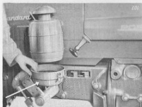
Fig. 4 Luftrenaren med avtagen oljebehållare. Pilen markerar nivåmärket.
