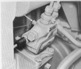
Fig. 40 Luftning av insprutningspumpen Luftningsskruv se pilen
