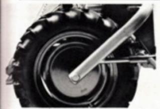
Modell ST är utrustad med en kraftig rörbygel vilket ger en kraftig och styr konstruktion som skyddar hjulen mot skador vid eventuell påkörsning. Det »bakräktidat»-hjulmontaget säkrar en jämn gång även vid höga hastigheter.
