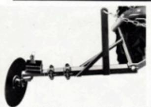
Markörerna är försedda med dammitäta lager och kan ställas in så att de allt efter förhållandena ger en korrekt markering. På maskiner med 3 m arbetsbredd och uppåt ger teleskopören möjlighet till såväl hjul- som mittmarkering. För tung jord finns markörvikter (extra utrustning).
