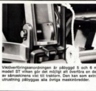
Viktöverföringsanordningen är påbyggd 5 och 6 m modell ST vilken gör det möjligt att överföra en del av såmaskinens vikt till traktorn. Den kan som extra utrustning påbyggas alla övriga maskinbredder.
