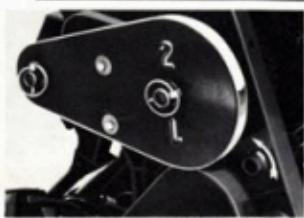
Transmissionen mellan växellåda och såxel är en lätt hanterlig kapslad enhet som kan vändas 3 gånger. Transmissionsaxeln 3 är speciellt avsedd att användas vid sådd av årtor, bönor och motsvarande utsläden.
