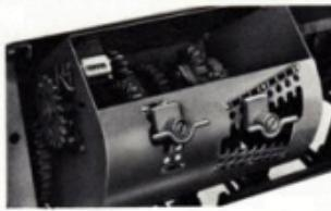
Den inkapslade, smörfria växellådan kan ställas in med intervaller på endast 5%. Alla 128 växelsteg är effektiva och utan överlappningar. Arealmätaren (levereras som extra utrustning) är direkt avläslbar och ger en korrekt kontroll av den sädde arealen.
