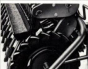
Den robusta och kraftiga STEGSTED efterharven kan spara ett arbetsmoment och är lätt att montera. Harvens arbetdjup kan regleras. Harven levereras tvådelad från 3 m och däröver.
