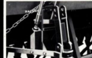
Den patenterade halautomatiska markörskiftaren ställas in för antingen växelvisa markering på båda sidor eller för permanent markering på samma sida. Centralinställningen ger möjlighet till snabb ändring av trycket på samtliga biller på en gång.
