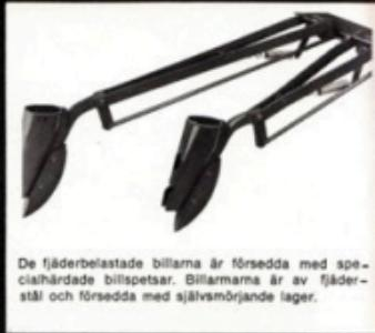
De fjäderbelastade billarna är försedda med speciellt hårda billspetsar. Billarmarna är av stål och försedda med självsmyrjande lager.
