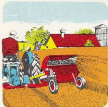
TAARUP DM 1100 sönderdelar och sprider halm för nedplöjning.
