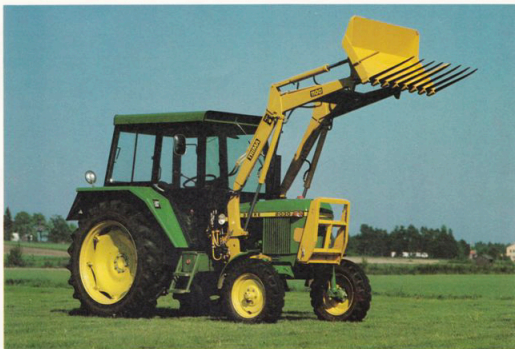
TRIMA 1100. Dubbelverkande lyftkolvar, hydraulisk redskapsmanövrering.
