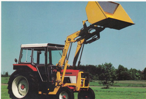
TRIMA 1510. Dubbelverkande lyftkolar, hydraulisk redskapsmanövrering.
