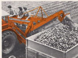
FAUN 1630 potatissupptagare för uppsamling direkt i bredvidgående vagn.
