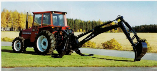
Grävaggregaten Valmet 25 och, på bilden, Valmet 30 har en robust konstruktion och kan enkelt monteras på traktor som därigenom kan få nya arbetsuppgifter
