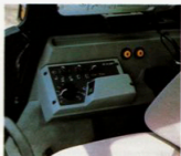
Autocontrol-panelen är bekvämt placerad. Genom en vipprömbrytare manövreras enkelt redskapets lyftning och sänkning. Vid lyftning av redskapet kan lyfthöjden förinställas
