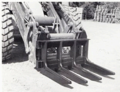
Stenbrytare för hjullastare. Avsedd för uppbyggnad och borttransport av stor sten, stubbar m.m.
