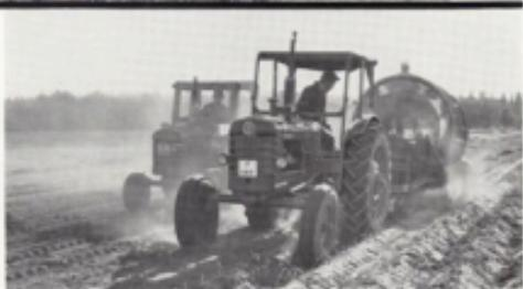
Boxer är beroende på den robusta konstruktionen, den stora frigångshöjden, den snabba vändräderna och den lättviktade motoren väl lämpad för hårdt slagsjöld. Dessutom är Boxer som standard utrustad med differensialhjul.
