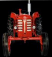
Boxer har en robust framaxel i stålkonstruktions och har en framhjul. Förlängningshjul är 48,5 cm. Framaxeln är försedd med en dragstöd.
