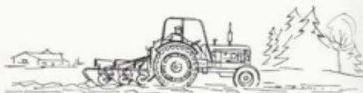
Boxer har Terra-Trol hydraulsystem med kombinerad fälg- och dragkraftsreglering vilket med redskap utan stödhjul ger ett jämnare bearbetningsdjup oavsett markytans och jordens beriktningsgrad.
