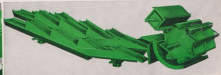
Cylinder med stor diameter och varierande drivning — slagsko med stor omslutning — långa skakare med stor yta
