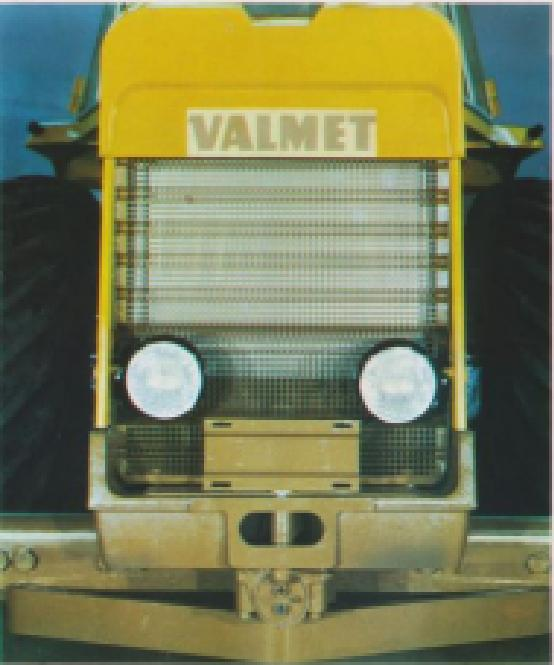
Valmet 900A: viktöverföringsläget. Vid lastcykel kraftöverföring från redskapsel och framaxeln till Valmet 900:s bakhjul. Effekten finns där den behövs.
