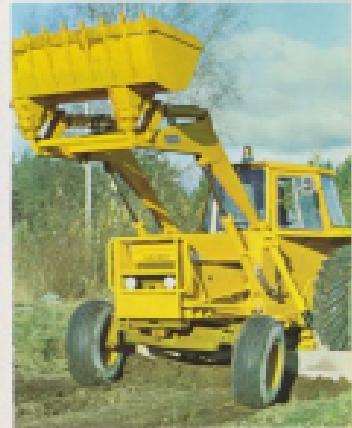
Valmet 900 är stadig och kraftig in i minsta detalj. En maskin, som fungerar, håller — arbetar. Den är verkligen något att komma med: 90 hästkrafter, tillåten framaxelbelastning 5000 kg, bakaxelbelastning 12000 kg, hydrauliktryck 175 kp/cm<sup>2</sup>, lyftkraft hos dragstängerna 2500 kg, tryckreglering på vilken världspatent har sökts. Extra mångsidigt
