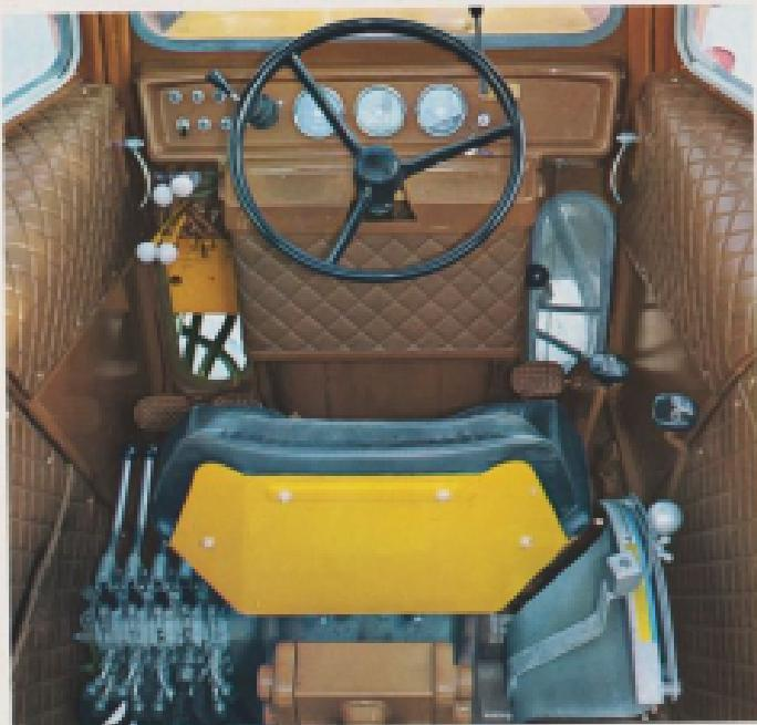
Styrhyttan är taktalet trippel och ändamålsenlig. Varm och dragfri. God ventilation och ljudisolering. Beklädd med slitstark och tvättbar plastivär. Sitzen kan regleras i höjdled, framåt-bakåt och efter förarens vikt. Instrumentbrädan är välutrustad med alla behövliga mätare och
