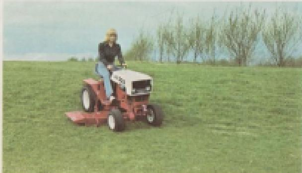
**VOLVO BM MINI 16 hk**, den "stora" minitraktorn med komfort för långa arbetspass. Även denna har till utfränden, med mekanisk transmission, 6 växlar framåt, 2 bakåt eller hydraulisk (stegelös) hastighetsreglering. Dessutom med 2-cylindrig boxer-motor.
