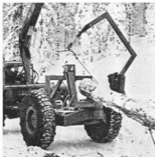
Den först specialtillverkade Brunett-traktorn med klänbanke. Massörenare med VSA-vinck. Griplåsaren är en Miab 177 försedd med hydrauliskt utskjut.
