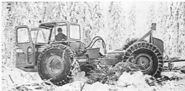
Bakvagnen på Brunett 5000 är här utrustad för stropflättning och försedd med V.S.A.-vinsch, som har en dragkraft på 3 ton.
