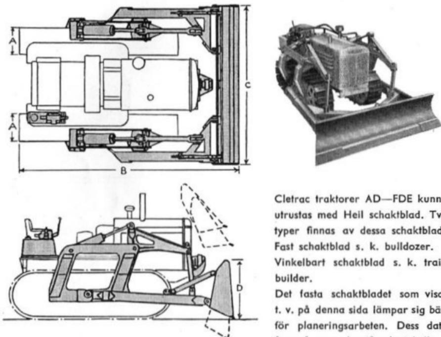
Cletrac traktorer AD—FDE kunna utrustas med Heil schaktblad. Två typer finns av dessa schaktblad: Fast schaktblad s. k. bulldozer. Vinkelbart schaktblad s. k. trail-builder. Det fasta schaktbladet som visas t. v. på denna sida lämpar sig bäst för planeringsarbeten. Dess data framgår av nedanstående tabell:
