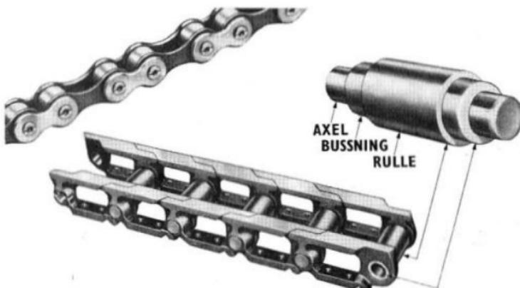
Längst t. v. visas en del av en rullkedja — den mest lättgående drivkedja som konstruerats. Rullkedjans kontakt med drivhjulet går över rullar som löpa fritt och detta gör att hela kedjan löper lättare och håller längre. Oliver använder denna princip på banden hos Cletrac på modellerna AD—FDE.
