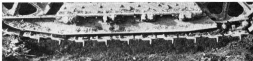
**Bandens effektiva konstruktion** kompletterar den fördelaktiga differentialstyrningen. Genom att banden alltid är i rörelse kan gripskorna tas i större dimensioner och därigenom alltid säkert fäste från »för till akter».
