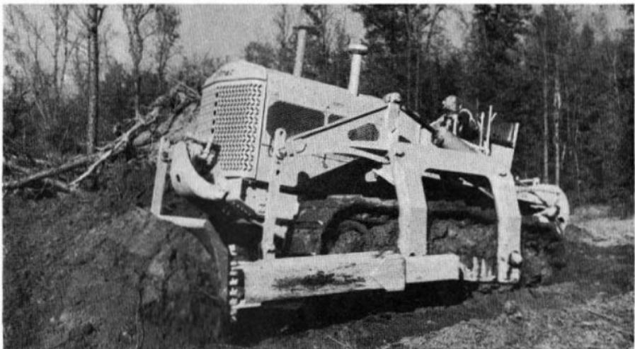
kan med sina 110 hkr på dragkroken utföra de tyngsta arbeten lekande lätt. Genom utrustningen med motorkontrollerad styrning är Cletrac FDE värdefull som dragare för självlastande schaktvagnar, vilka oftast i kuperad terräng kunna hårt pressa föraren. Stora stenar, stockar, dåligt väglag, blöta marker och liknande förhållanden inverka icke på modell FDE:s prestandsförmåga.
