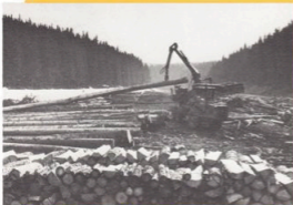
I Tjeckoslovakien tar en ÖSA-processor hand om hela träd på ett avlägg där man som synes även tar ut brännved.
