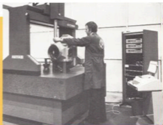
En kvalificerad koordinatmätutrustning används för att kontrollmåta hela komponenter med stor precision.
