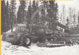
Med den midjestyrda SM 868 med gripplastare var tarrängstransporten helt mekaniserad. Maskinen blev världens mest sålda skotare.
