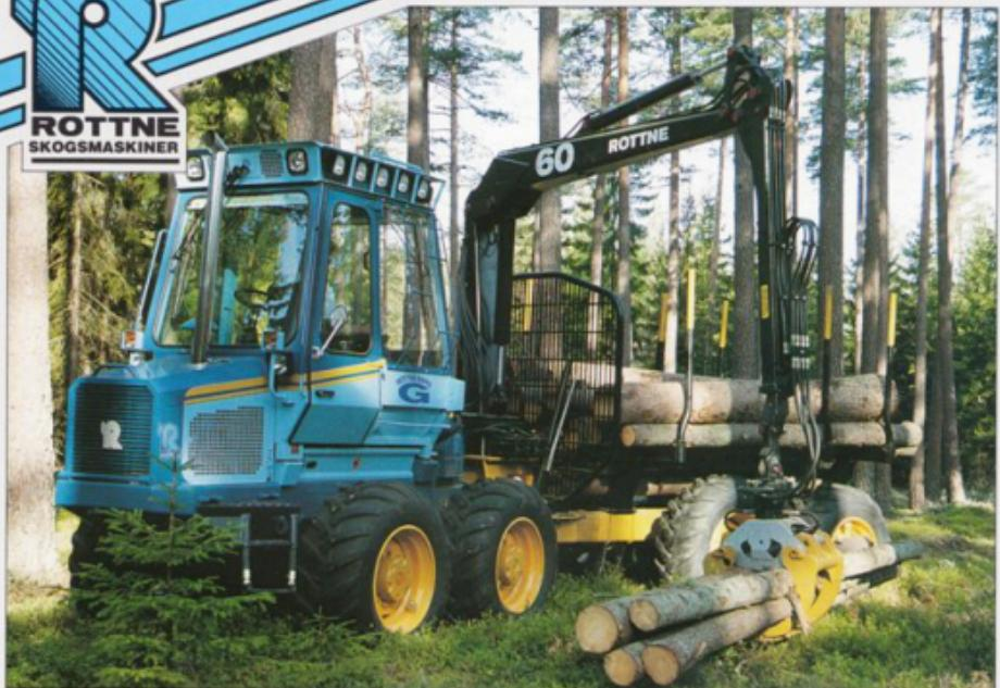
**ROTTNEs nya gallringsskotare** är liten och smidig och har suveräna köregenskaper genom hydrostattransmissionens unika styrelektronik.
