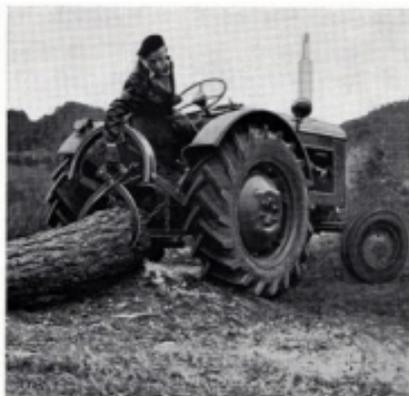
Från sin plats på traktorn har föraren god kontroll över de olika arbetsmomenten. Genom att timmersaxen är upphängd i traktorns trepunktslyft sker manövreringen smidigt med hjälp av hydrauliken. Från förarsätet reglerar föraren saxen så att den automatiskt kopplar eller släpper stockarna. Den önskade lyfthöjden erhålles genom att förkorta eller förlänga den kätting, varmed själva saxen är upphängd i ubalksbögen.
