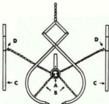
Ringen A fästs på dragbommen. Kättingarna B föres genom ringen och fästs på krokarna D, monterade i dragstängerna C.
