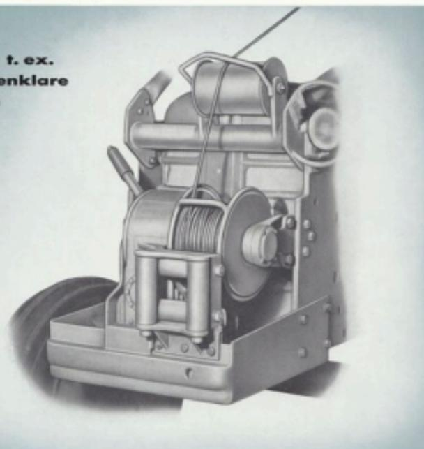
ÖSA-91 är en mekanisk vinsch som drivs direkt från motorns kraftuttag via snöckväxel och stöllamellkopplingar. Med hjälp av en speciell servo-cylinder och hydraulventil kan vinschen över fjärrmanövreras med kabel eller radio. ÖSA-91 är i första hand avsedd för mindre och medelstora traktorer och kan med fördel användas i kombination med enklare slinglastare eller som lunningsvinsch i kombination med en griplastare såsom All-Grip Junior ÖSA-69.
