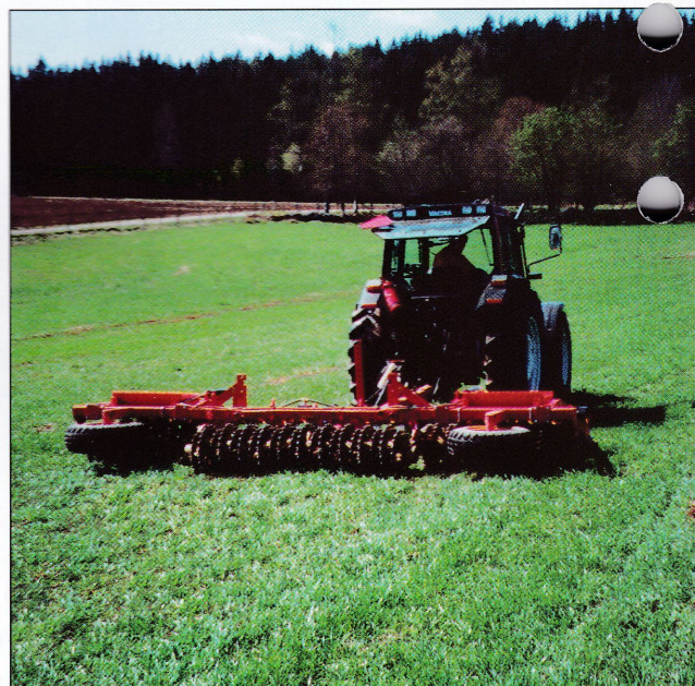
Crosskill-välten gör en mycket begränsad skada av de gröna bladen. Samtidigt som sten trycks ner, sker en luftning och ojämnheter mals ner och plattas ut.
