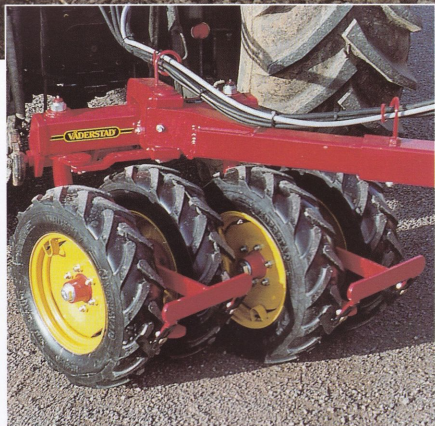
Den svängbara Pivo-packaren fullbordar begreppet "fullbreddspackning"
