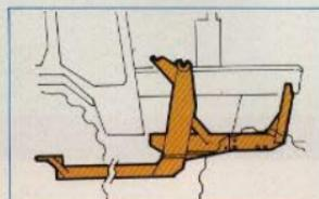
består av ett stabilt fundament, som oftast går till traktorns bakaxel. Enkel och säker lösning av lastare mot fundamentet med spännskruvar. Passar moderna traktorer med såväl 2- som 4-hjulsdrift.
