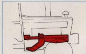
är det fästjärnsystem, som ÅLÖ introducerade redan 1958. Har du en äldre traktor med QUICKE fästjärn, passar de nya QUICKE-lastarna System E på den. Lämpar sig bäst för 2-hjulsdrivna traktorer.
