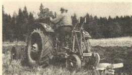
Som extra utrustning kan BM-10 förses med hydraulisk redskaplyft.
