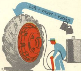
Med belastningsvikter på hjulen och vätskefyllda gummiringar ca 1800 kg.
