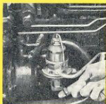
Bräcket pumpas till flutärluset med en pump som drivs direkt från komaxen. Ett lättredskamligt handtag för handpumpning sitter under pumpen.
