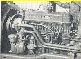
Motorn är lättast och lättredskamlig. Den har en modern fallförgasare och batteriförbindning. Hydraulpumpen drivs direkt från motorn.
