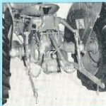
Den starka hydrauliska lyften har en oljepump som drivs direkt från motorn - den arbetar därför helt oberoende av kopplingen.
